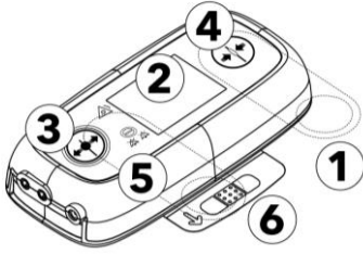
Der Assistent. 1. Zuglasche 2. Display 3. Aufblasen-Taste 4. Entleeren-Taste 5. Bestätigungstaste 6. Klebepad-Zuglasche
